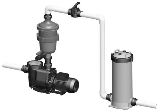
Instalación del filtro de cartucho con válvula de cierre de dos vías
